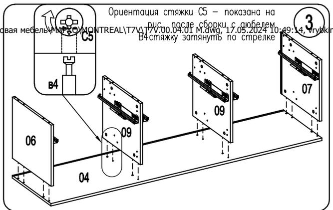
Ориентация стяжки C5 - показана на рис. после сборки, с дюбелем в4 стяжку затянуть по стрелке
